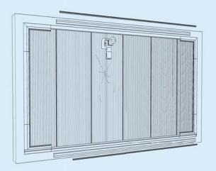
Je nach verwendeten Rahmenprofilen sind die Dichtungen sowie Klemmleisten im Bereich des defekten Paneels zu entfernen.
