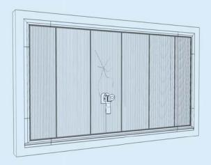
Das defekte Lichtbauelement ist mit geeignetem Werkzeug (z.B. Stichsäge) aufzutrennen.
