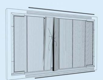
Das defekte Lichtbauelement kann somit aus der Fassade entfernt werden.
